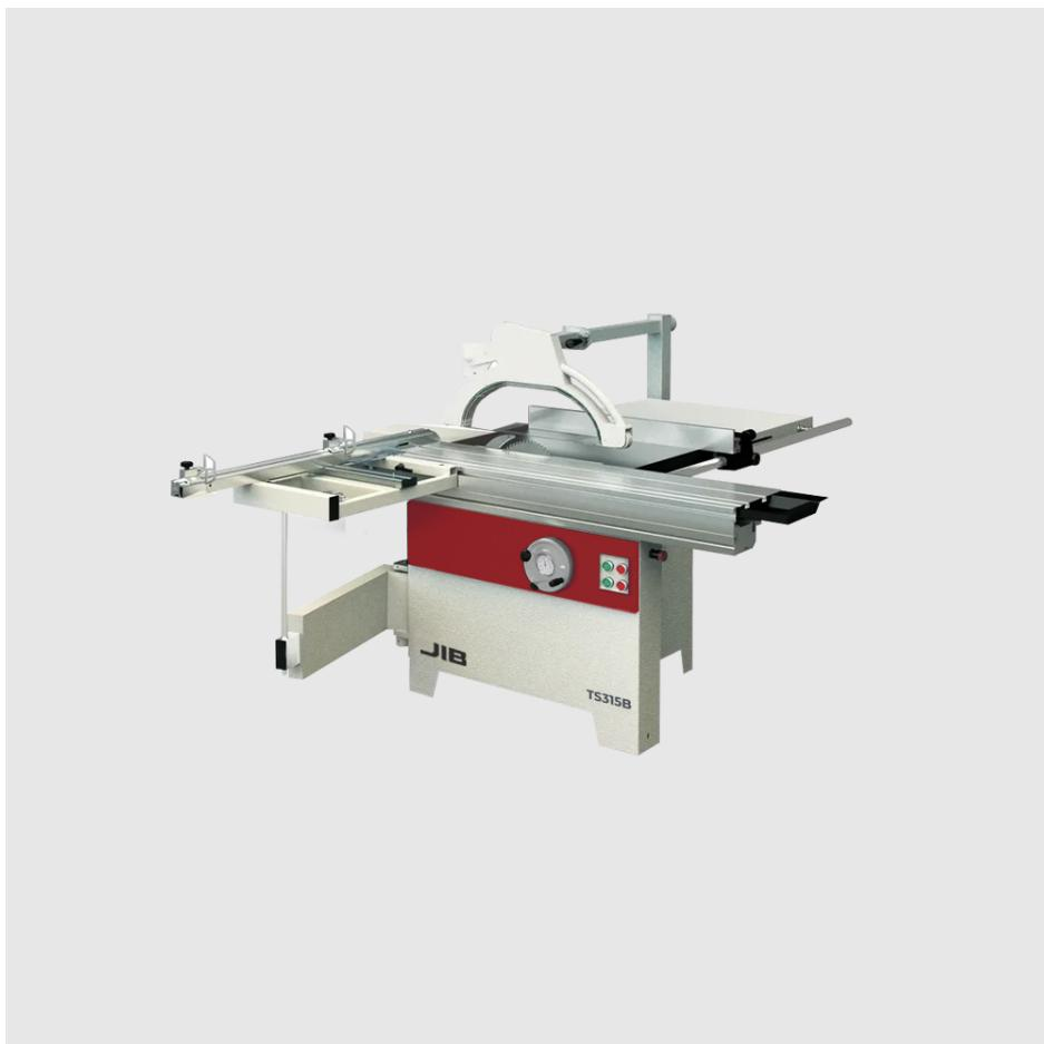
Асинхронный двигатель повышенной мощности 4 кВт 400В Подвижный стол с ходом каретки 3200 мм Подрезной диск расположен перед основным диском и позволяет проводить распиловку плитных материалов без риска появления сколов Корпусная конструкция Пила наклоняется от подвижного стола Большой чугунный стол с чугунными удлинителями для обеспечения максимальной опоры материала. Подвижный угловой упор для использования в Т-образном пазу с предустановленными углами на 45° и 90°.
